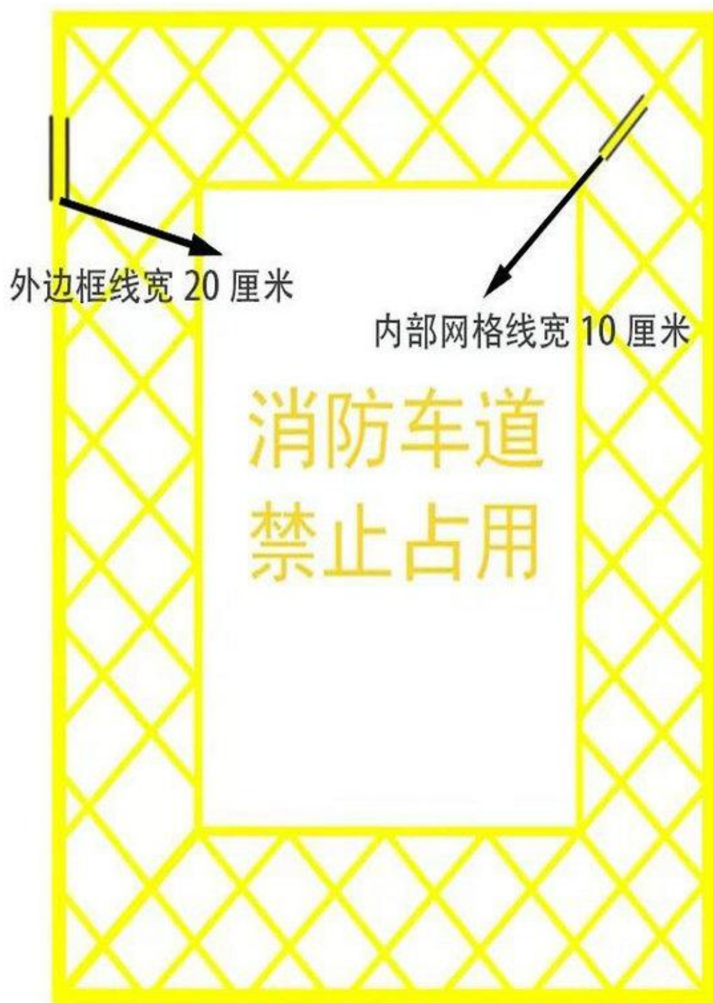
图二：消防车通道出入口禁停标线及路面警示标志示例
